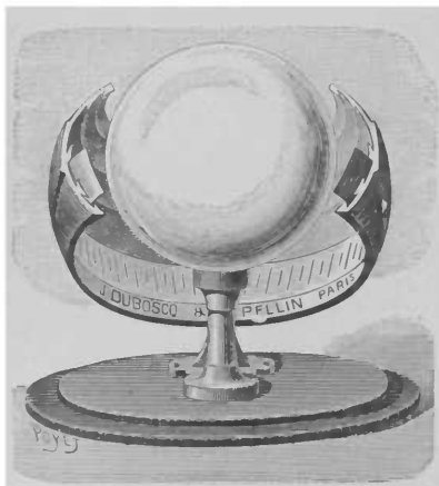
Fig. 236. — Héliographe de Campbell construit par M. Pellin.
