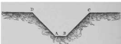
Fig. 180. — Coupe d'une rigole en sol perméable.
