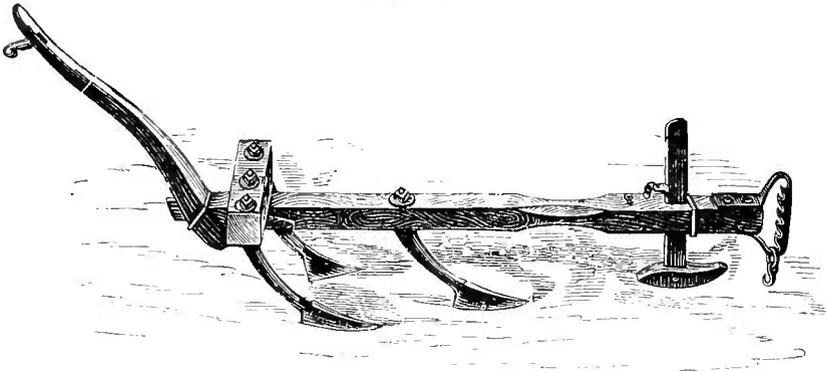
oder weiter gestellt werden können. Die Zeichnung Fig. 73 wird diese Construction verdeutlichen, und bleibt nur hinzuzufügen, dass man statt der Stelze auch ein Rädchen, sowie dass man verschiedene Formen von Schaaren oder auch horizontalstehende Messer hat, s. Fig. 74.
