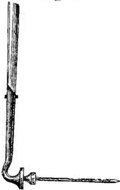
k) Um die Röhren einzulegen, bedient man sich eines dazu geformten Hakens mit langem Stiel, Fig. 7
