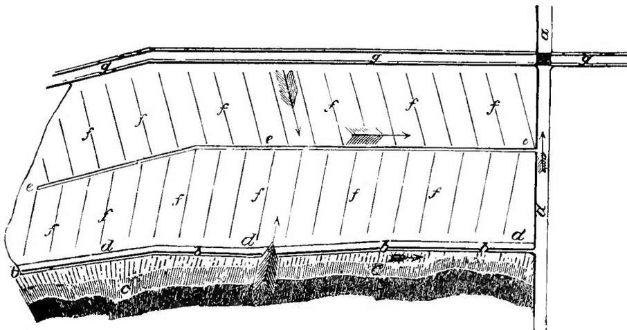
Fig. 2 ist eine Skizze der Drainage eines Grundstückes. Dasselbe hat ein Hauptgefälle und ein Gefälle von beiden Seiten. a, a ist der Hauptabzug; b, b offener Auffanggraben; c, c angrenzende Anhöhe; d, d isolirter Kopfdrain; e, e Sammeldrain; f, f Saugdrains; g, g Strasse mit Gräben.
