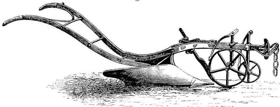
Bei den Pflug-Vorderkarren älterer Construction muss das in der geöffneten Furche gehende Rad einen grösseren Durchmesser als das andere haben, damit der Vorderkarren eine mehr waagrechte Stellung beim Pflügen behält. Ferner muss der Pflugbaum nach vorne etwas aufsteigen, so dass durch das Vor- oder Rückwärtsstellen hauptsächlich die Furchentiefe regulirt wird.
