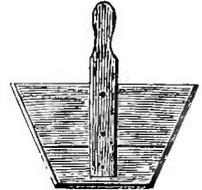
Zum Wassereinlassen oder Absperren bei den kleinen Gräben (Wässerungsgräben) genügen kleine Einsatzbretter, sogenannte Stau- oder Stechbretter (Fig. 114).
