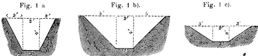
Fig. 1 erläutert das eben Gesagte. Bei einer Grabentiefe von 4 Fuss und einer Solenbreite von 2 Fuss zeigt sich das Profil a) von einer halbfüssigen, b) von einer einfüssigen, und bei einer Grabentiefe von 2 Fuss zeigt c) das Profil einer  $1\frac{1}{2}$ füssigen Böschung.
