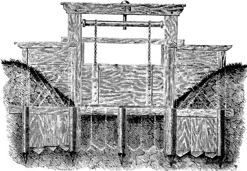
Fig. 108 zeigt uns die Hauptconstruction einer Hauptschleuse mit zwei Aufzügen im Querschnitt und in der vorderen Ansicht; Fig. 109 eine solche mit einem Aufzug.
