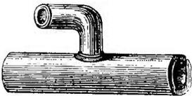
l) Die Sammeldrains legt man, wenn möglich, um 1 bis 2 Zoll tiefer als die Saugdrains. Durch gekrümmte Röhrstücke, Fig. 8, werden die Ausflüsse der Saugdrains in die Sammeldrains eingelassen.
