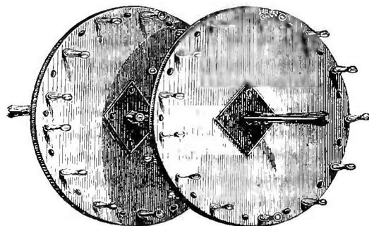
Saatwelle kann gewechselt werden mit anderen, deren Löffel grösser oder kleiner sind. Dadurch und durch die Schnelligkeit der Umdrehung,
