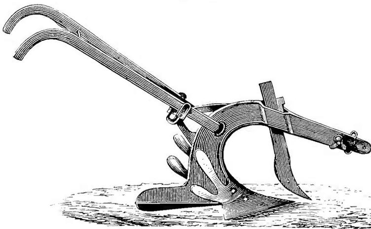
Kartoffelerntepflug. Bei dessen Anwendung längs der durch das Anhäufeln entstandenen Reihen wird das Instrument tief genug gestellt,
