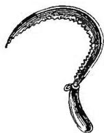
Arbeit, aber bedeutend mehr geleistet, als mit jenen. Der Hauptvortheil der Sichel ist, dass stark gelagertes, verworrenes Getreide damit allein noch gut abgebracht werden kann, und dass Weiber und selbst stärkere Kinder damit arbeiten, also bei der Ernte beschäftigt werden können. Dagegen kostet die Arbeit mit der Sichel weit mehr und es bleiben höhere Stoppeln als bei Anwendung der Sense.
