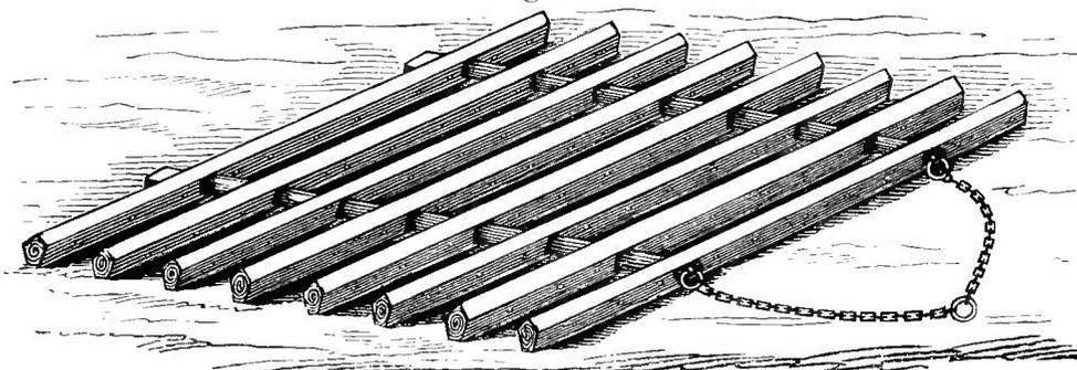
Die Bälkchen sind 8 bis 9 Fuss lang, und unten, sowie an der vordern Kante mit Eisen beschlagen. Die Entfernung der Balken von einander, gebildet durch die über die beiden Kettzüge eingeschobenen Hülsen, ist 5 Zoll.
