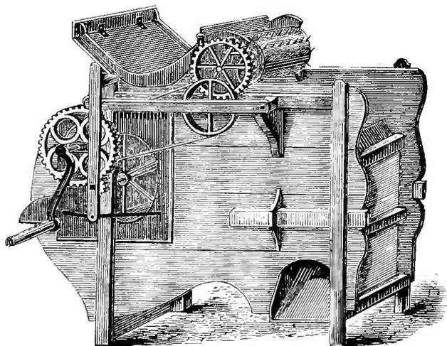
sich hierzu die grosse Hornsby'sche Maschine, welche oben mit einer, die in der Druschmasse befindlichen kürzeren Strohtheile entfernenden stachligen Walze versehen ist (s. Fig. 97). Zum Putzen von minder mit Stroh vermengten Druschmassen, oder zum völligen Reinigen und Sortiren des Aus-
