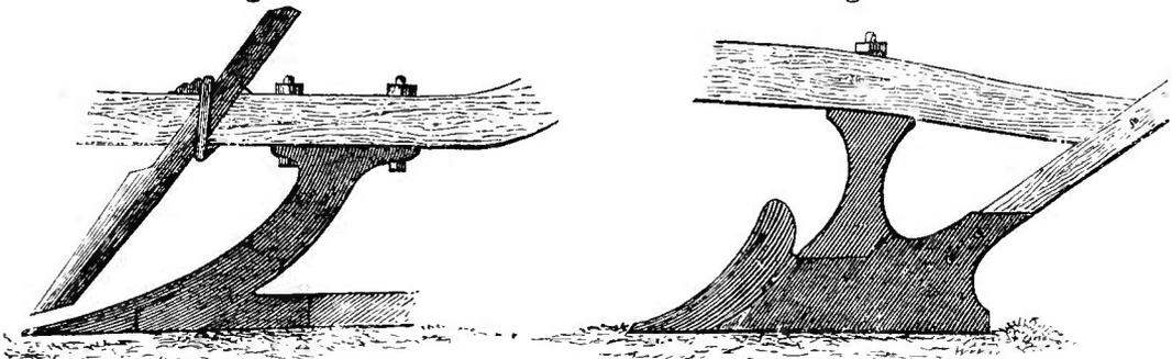
In losem Boden ist das Sech ganz zu entbehren. Das Sech wird entweder in den durchlöcherten Pflugbaum eingekeilt, oder — was besser ist — mittelst einer Stellschraube gegen den Pflugbaum festgestellt.
