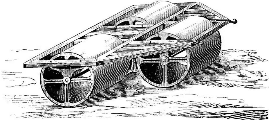
gusseisernen Walze sind die einzelnen Cylinder 1.7 Fuss lang und 1.5 Fuss im Durchmesser. Die ganze Walze hat ein Gewicht von nahebei 7 Centnern.
