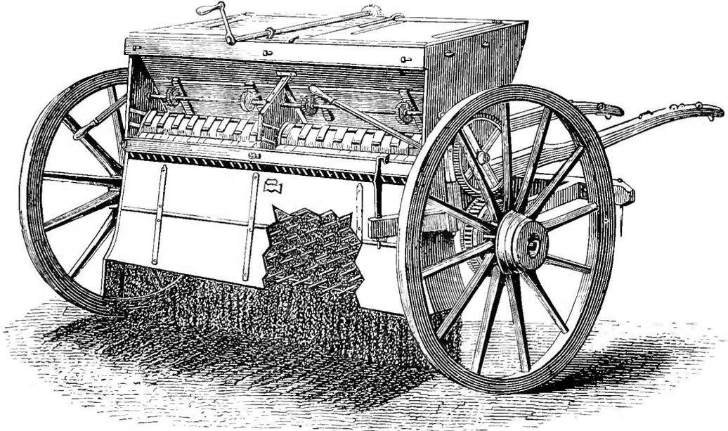
hinten offenen Maschine sichtbare Hauptwalze ist mit gekerbten Scheiben versehen, welche das Düngepulver aus dem oberen Kasten nach dem unteren fördern. Letzterer ist gegen den Boden offen, die 2 langen Wände aber sind innen mit Stiften besetzt (s. die durchbrochene Stelle der Zeichnung), damit sich der Dünger im Herabfallen noch besser vertheile.
