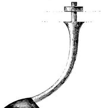
meisselförmigen Fussenden (Gänsefüsse) eignen sich für schwereren festeren Boden: für Mittelboden dienen 3- bis 4zöllige, für leichten Boden bis 5 Zoll breite Schaarchen.
