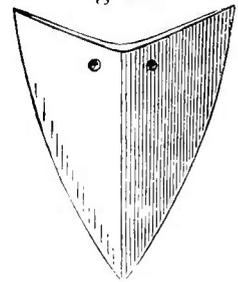
b) Das Sech, Pflugmesser, Kolter. Das am Pflugbaum befestigte, gegen die Schaarspitze gerichtete Sech dient zum senkrechten Abschneiden des zu pflügenden Erdstreifens. Zu dem Ende ist die Form messerartig, die Schneide sei scharf und die Stellung zur Scharsole in einem Winkel von etwa 45 Grad, s. Fig. 13 a. — Das Sech kann auch durch einen kantigen, aufwärts gerichteten Ansatz vom Schaar gegen den Pflughals ersetzt werden, s. Fig. 13 b.
