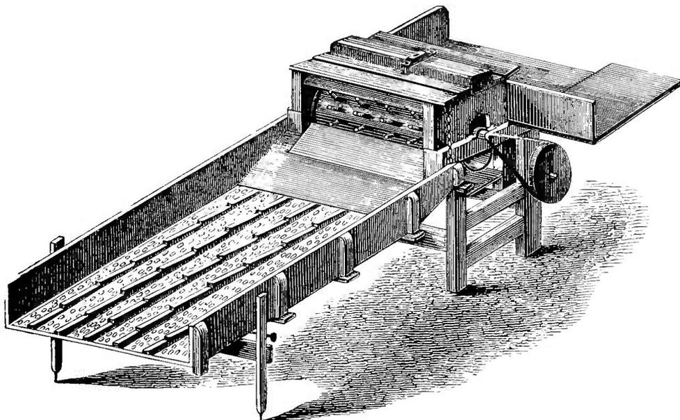
gezackten Schlagleisten, besonders als Handdreschmaschine in Ruf), Clayton und Shuttleworth, Hornsby u. A. — Ziemlich abweichend in der Construction der Dreschtrommel ist die in Oesterreich früher viel verbreitete Maschine von Seidl. Die Trommel ist von sehr kleiner Dimension aus Gusseisen und viermal mit je drei nahe zusammenstehenden scharfen Leisten versehen. Bei äusserst schnellem Umschwung der Trommel über einem Roste von Eisenstäben wird mit dieser einfachen Maschine gut gedroschen.
