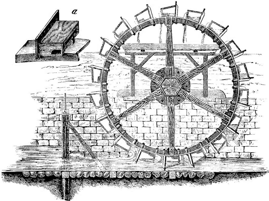
Eine gute Construction eines kleineren Schöpfrades ist durch Fig. 115 verständlich. Dasselbe hat Nuss (um den Wellbaum) und Radkranz aus Gusseisen auch besser construirte hölzerne Kästchen, welche zugleich mit den Wasserschaukeln verbunden sind (s. *a* der Fig. 115 im grösseren Maasstabe). Im Grossherzogthume Hessen in ein gemauertes Gerinne eingesetzt, hob es per Secunde  $\frac{1}{3}$  Kubikfuss Wasser 7 Fuss hoch.
