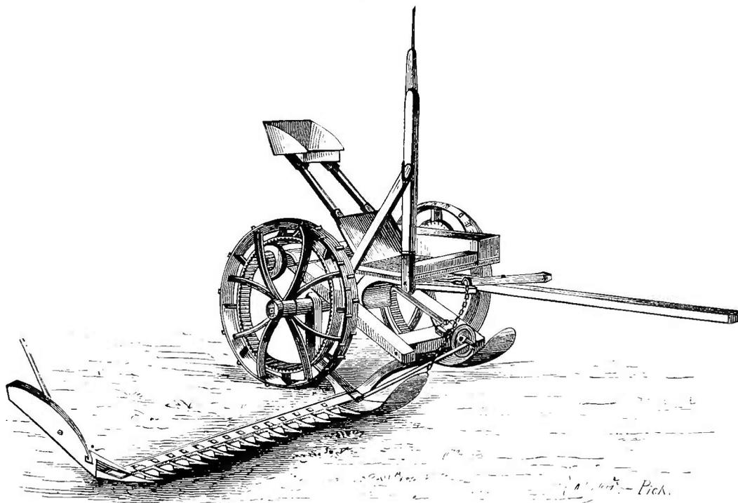
Zugkraft bedürfen als die Getreidemähmaschinen, und bei 4' Breite mit 2 mittelstarken Pferden leicht fortbewegt werden.
