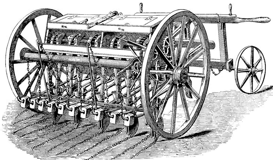
Eine weitere Werthserhöhung erhalten die Maschinen dieser Construction, dass sie zu kleinen wie zu grösseren Samen gleich gut verwendbar sind und dass man die Entfernung der Saatreihen von 4 bis 24 Zoll bestimmen kann. Diese Maschinen nach dem Löffelsystem haben alle anderen überflügelt; man baut sie 9- bis 18reihig. Sie erfordern aber eine sorgfältige und sachkundige Behandlung, eine im Verhältniss
