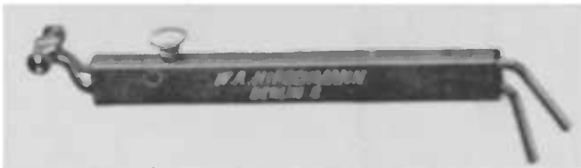
Fig. 50. Scheech'scher Handgriff für Brenner.
