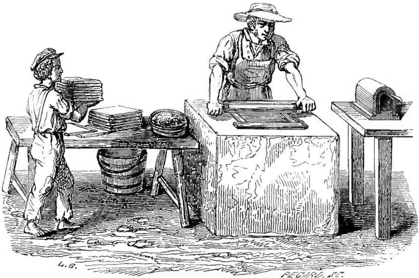
Fig. 119. — Roulage d'une tuile dans son moule.
