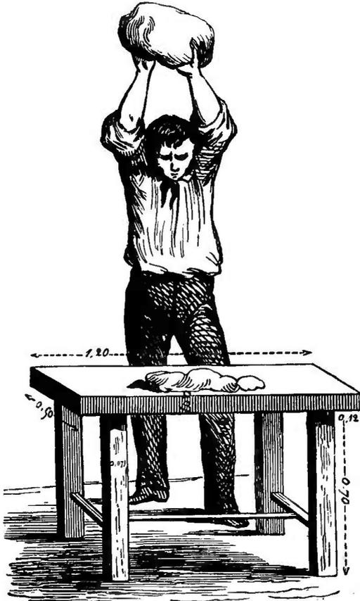
Fig. 71. — Pétrissage de la terre épurée.
