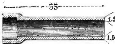
Fig. 64. — Coupe longitudinale d'un tuyau à renflement.
