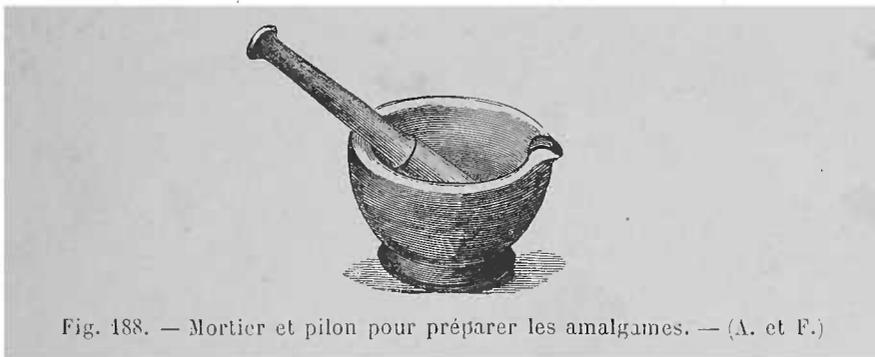
Fig. 188. — Mortier et pilon pour préparer les amalgames. — (A. et F.)
