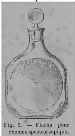
Fig. 2. — Flacon pour examen spectroscopique.
