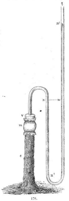
176. c Cep de vigne coupé à cinq décimètres de terre. — / Tube de verre à double courbure ajusté sur une virole en cuivre v qui est adaptée et lutee à l'extrémité coupée du cep, l'appareil étant recouvert et maintenu par un morceou de vessie m. — nn Ni-
