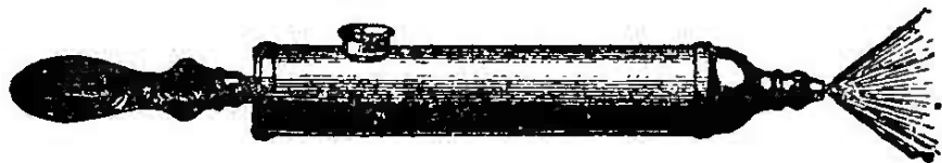
FIG. 254. — Jeringa-pulverizador (Clisé Vilmorin )
