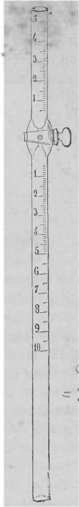
Fig. 230. Uréomètre à mercure.
