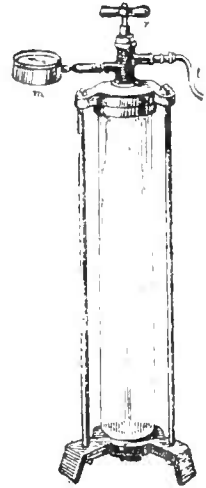
Fig. 97. — Appareil servant à comprimer l'oxygène à 5 atmosphères.
