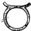
Fig. 257. — Coupe d'un tuyau gouttière en fonte.
